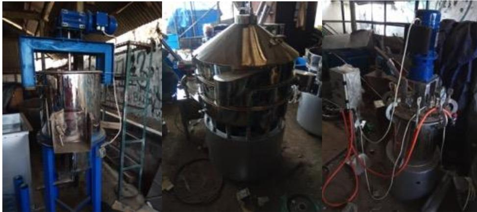
Gambar 22. Lini proses produksi pupuk biosilika cair yang memanfaatkan abu sekam sisa pembakaran tungku
