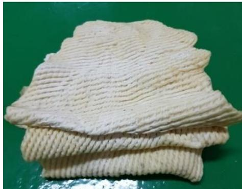
Gambar 13. Lateks yang telah digumpalkan menggunakan koagulan asap cair
