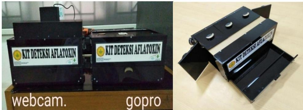
Gambar 15. Kit deteksi aflatoksin pada jagung
