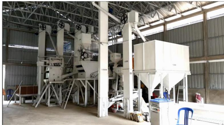
Gambar 21. Konfigurasi mesin penggilingan padi *auto-pneumatic system* kapasitas 1,5 ton/jam
