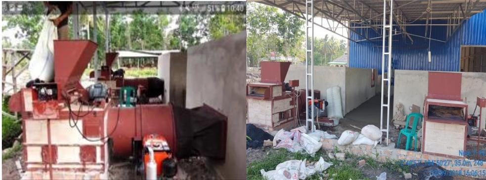
Gambar 20. Unit pengering kapasitas masing-masing 6 ton/muat tipe *flat bed* dengan tungku pemanas model *Semi-automatic Fed Down Draft Rice Hull Furnace*
