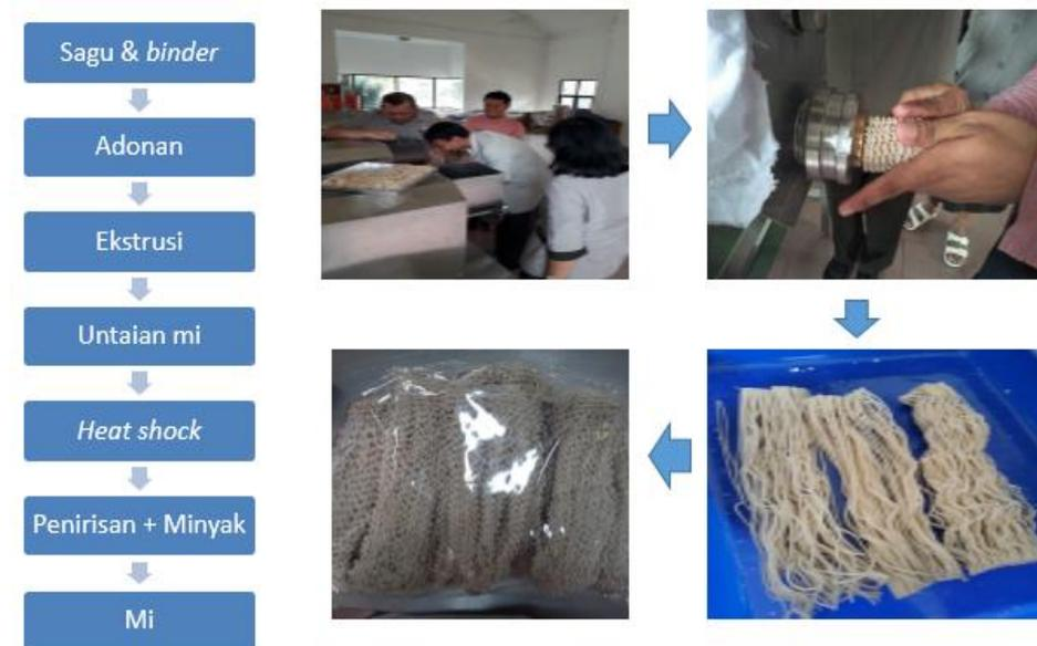
Gambar 50. Produksi mi sagu kering dengan ekstruder
