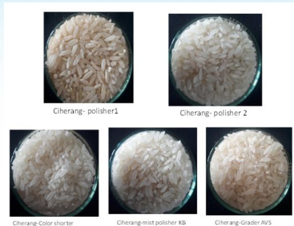
Gambar 21. Tahapan *whitening* beras mulai dari *polisher* I hingga *mist polisher* untuk sampel beras dari padi var. Ciherang
