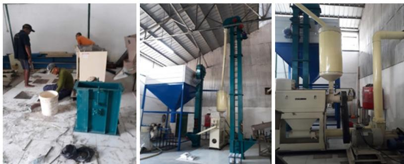
Gambar 20. Instalasi alat *mist polisher* KB40G dengan elevator dan tanki produk
