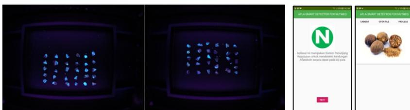
Gambar 6. Citra aflatoksin pada pala (kiri) dan tampilan antarmuka aplikasi deteksi cepat aflatoksin pada pala (kanan)
