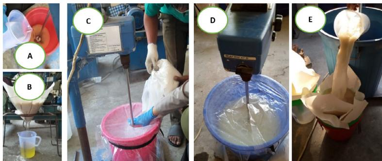
Gambar 14. Kegiatan proses *scaling up* modifikasi permukaan nanobiosilika sol-gel dengan umpan nanobiosilika 1 kg, 2 kg, dan 5 kg menggunakan teknik OSM dan TSM
